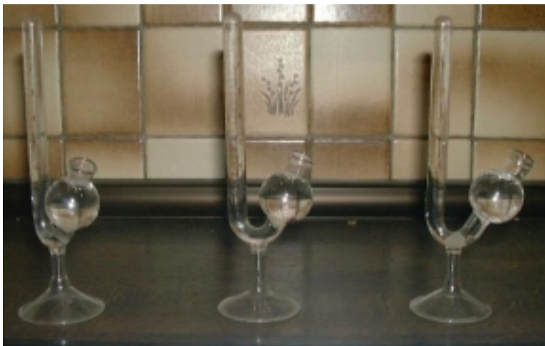
Abb. 1 Gärröhrchen nach EINHORN mit Fructose, Maltose und Lactose
